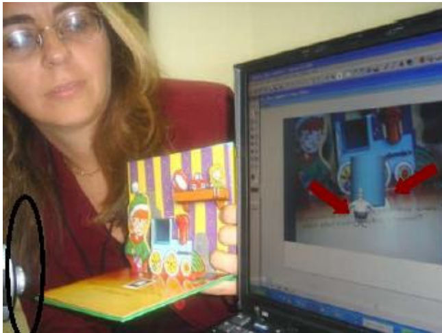
Figura 5: A Pesquisadora demonstrando seu protótipo de RA: No extremo esquerdo a webCam que filma o livro real e a direita sua imagem no monitor acrescida de elementos virtuais.
