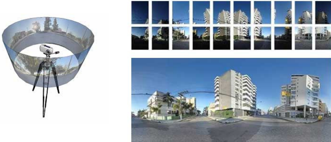
Figura 5 – Esquema de como se faz o levantamento fotográfico(esq.); Fotos levantadas e panorama finalizado(dir.)
