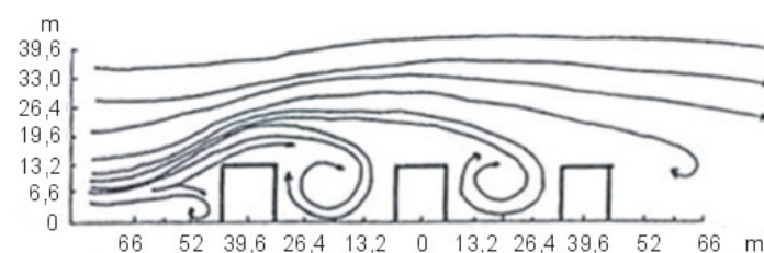
Movimento do ar sobre três edifícios baixos
